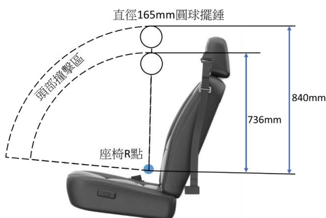
圖 2 頭部撞擊區（座椅照片來源：網路）
